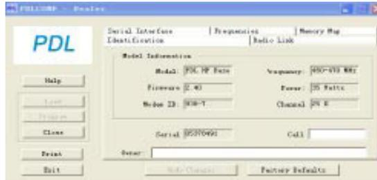
“Radio Link”选项卡：建立电台间的通讯，所需要设置的为四个地方，要求基站电台和移动站电台设置完全一致才能保证电台间通讯成功。
