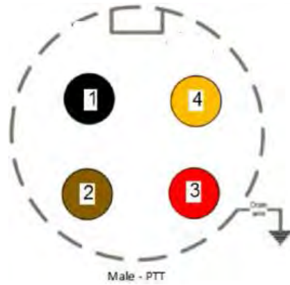
图 3 PTT 引脚说明图 (接线端)
