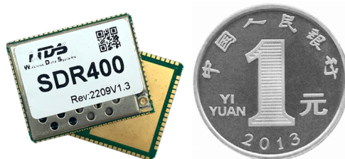
实际大小，重量仅 5 克！ 26.5x33x3.5mm (TTL, 3.3/3.6V)
