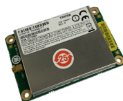
TRM 2 瓦收发板 (同步 SPI 接口、3.3V、MMCX)
