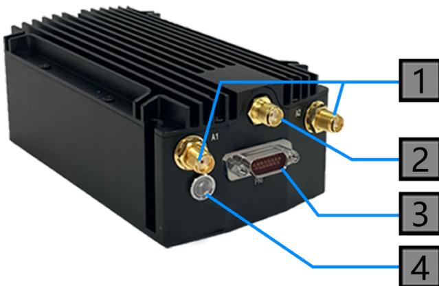
**1** 1-2 射频天线连接端口 [SMA 母]
